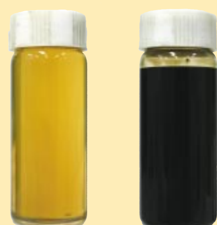
新品のエンジンオイル 2万キロ走行したエンジンオイル
