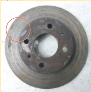
ディスクパットの摩擦材がなくなった状態で使用したディスクローター
