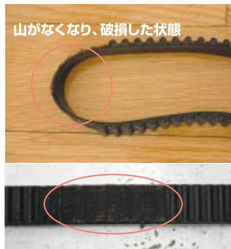
経年劣化によりコマが飛んだタイミングベルト
