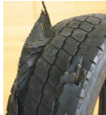
バースト(破裂)したタイヤ
