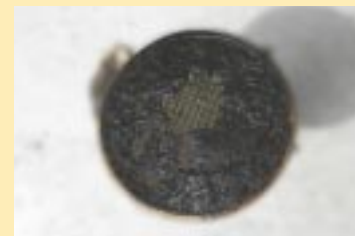
目詰まりしたオイルストレーナー
