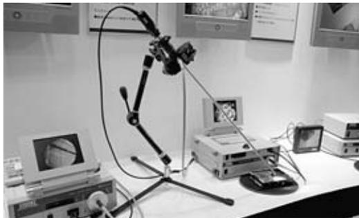
分解や破壊を行わずにチェックができるスコープ類も展示されていた。写真は基盤など細微なものをチェックできるマクロスコープ。担当者は「修理＝部品交換」という現状を嘆いていた。
