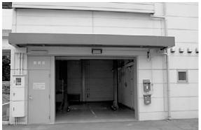
燃料電池自動車の整備室入り口。室内は今までの整備作業場とは異なり、万一の水素漏洩時に火災や爆発が起こらないよう、室内換気・空調を始め静電気対策や防爆型電気設備の採用など、徹底した防爆・火災対策が施されている。
