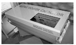
「キャパシター」と呼ばれる補助動力装置。燃料 電池車走行時に回収できるエネルギーを電気とし て蓄電し、短時間に放出することでモーターの出 力を高めるのに用いられる。一種のコンデンサー である。
