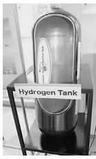
燃料電池車に積まれる「水 素タンク」。350気圧という 高圧の水素ガスを安全に保 管するため、数々の特殊技 術が施されている。
