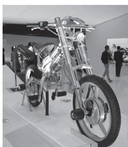
前後輪にブラシレスDCモーターを装備した二輪駆動の電動バイク。インホイールモーターの採用により車体レイアウトの自由度が広がったのを生かし、アルミフレームボディを上下・前後に伸縮する機能を備えています。
