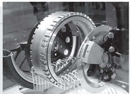
ランサーエボリューションをベースにした電気自動車。最高出力50kw、最大トルク518N・mのインホイールモーターを4輪(20インチホイール)それぞれに配置し、最高出力200kw(270PS)を発揮します。
